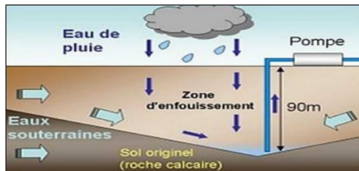
Figure 4 : Schéma représentant la Formation de lixiviat ( Laceb et Meziani,2013 ).
